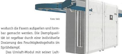
Das Umluft-Modul mit seiner Luftführung glättet und streckt das Kleidungsstück, welches durch Heißluft gleichzeitig getrocknet wird. Die neue Gebläse-Generation arbeite hoch effizient und energiesparend bei geringem Geräuschpegel. Auch in diesem Kompaktfinisher ist für sicheren Transport
