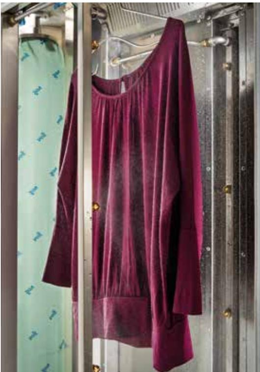
Ausschlaggebend für die überzeugende Finish-Qualität ist die Hochdruck-Wassersprüh-Technologie. Das mikrofein zerstäubte Wasser dringt leicht in die Fasern ein und bringt sie zum Quellen. Die Wirkung ist beeindruckend: Selbst harte Legefalten, zum Beispiel bei Leinenmaterial oder Jeans, verschwinden. Auch der sogenannte Wascheffekt an der Ware tritt nicht auf.
