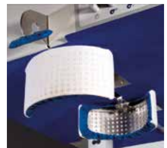
LÄNGSBUNDSPANNER Der Längsbundspanner spannt Bundumfanggrößen von 58–129 cm.
