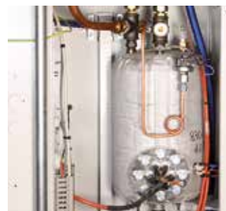
DER EINGEBAUTE DAMPFERZEUGER Für Leistung auf engstem Raum: Der Hosentopper VEIT 8741 Längsspanner mit eingebautem 9 kW Dampferzeuger.
