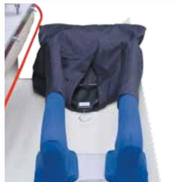
Spezielle Sakkoablage verhindert Beschädigung bereits gebügelter Partien
